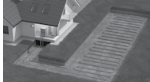
Bomba de Calor (geotérmica)
